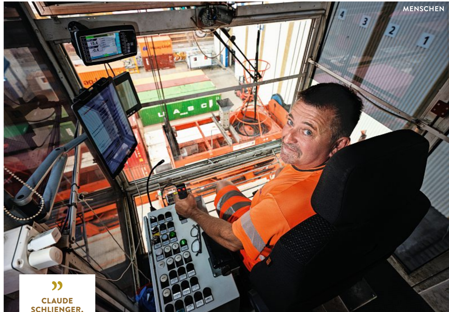
Kranführer Schlienger in seinem Cockpit. Von hier aus platziert er die Arretierzapfen passgenau am Container, um diesen anzuheben – eine knifflige Angelegenheit.
